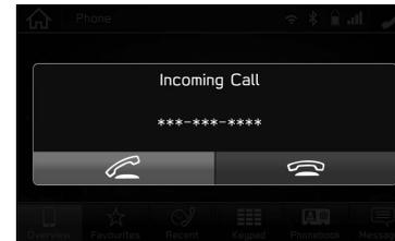
**Anruf ablehnen:** Wählen Sie oder drücken Sie den Schalter am Lenkrad.
