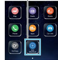
**Die Lage der Bildschirmtasten kann durch Auswählen und Halten geändert werden; dann werden sie in die gewünschte Position gezogen.**
