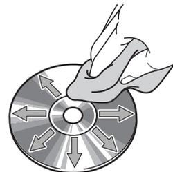
**Um eine Disc zu reinigen:** Wischen Sie sie mit einem weichen, fusselfreien, mit Wasser angefeuchteten Tuch ab. Wischen Sie in geraden Linien von innen nach außen (nicht mit kreisenden Bewegungen). Trocknen Sie sie mit einem anderen weichen, fusselfreien Tuch ab. Verwenden Sie keine herkömmlichen Schallplattenreiniger oder antistatischen Mittel.
