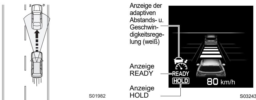
Unabhängig davon, ob sich vor Ihnen ein Fahrzeug befindet, leuchtet **READY** (Anzeige READY) auf, wenn das Bremspedal kräftig durchgetreten wird, während das Fahrzeug steht. Wenn Sie zu diesem Zeitpunkt den Schalter RES/+ oder den Schalter SET/- betätigen, wird die Brems-Haltefunktion aktiviert.
