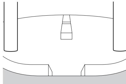
Der Bereich über der Kamera kann nicht eingesehen werden. Wenn ein Gegenstand im oberen Bereich über einen breiten Überstand verfügt, z. B. ein Schildermast, kann der Überstand auf dem Bildschirm nicht erkannt werden.
