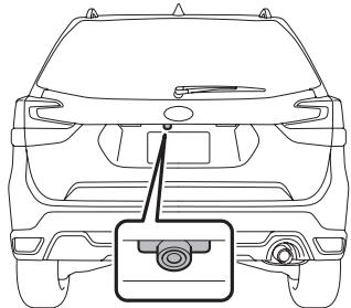
Wenn sich der Zündschalter in der Position „ON“ und der Wählhebel in der Position „R“ befinden, zeigt die Rückfahrkamera automatisch das Bild der Sicht nach hinten hinter dem Fahrzeug an. Das Bild der Rückfahrkamera wird auf diesem System angezeigt.
